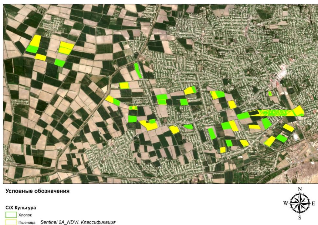
Рис. 9. Результат контролируемой классификации по Sentinel 2A
