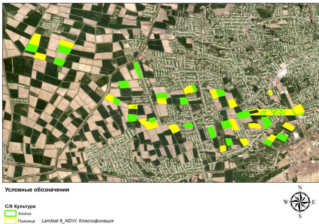
Рис. 8. Результат контролируемой классификации по Landsat 8
