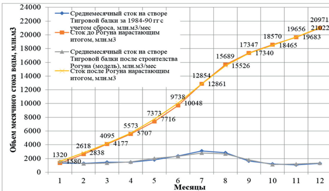
Рисунок 2. Сопоставление месячных и годовых стоков реки Вахи в створе «Тигровая Балка» до и после строительства Рогунского водохранилища.
