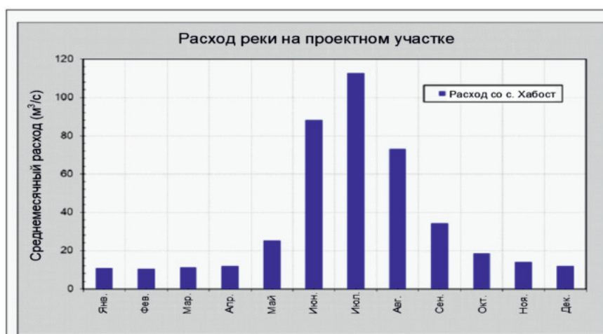
Рис.3. Среднемесячный расход реки Шохдара на участке строительства.
