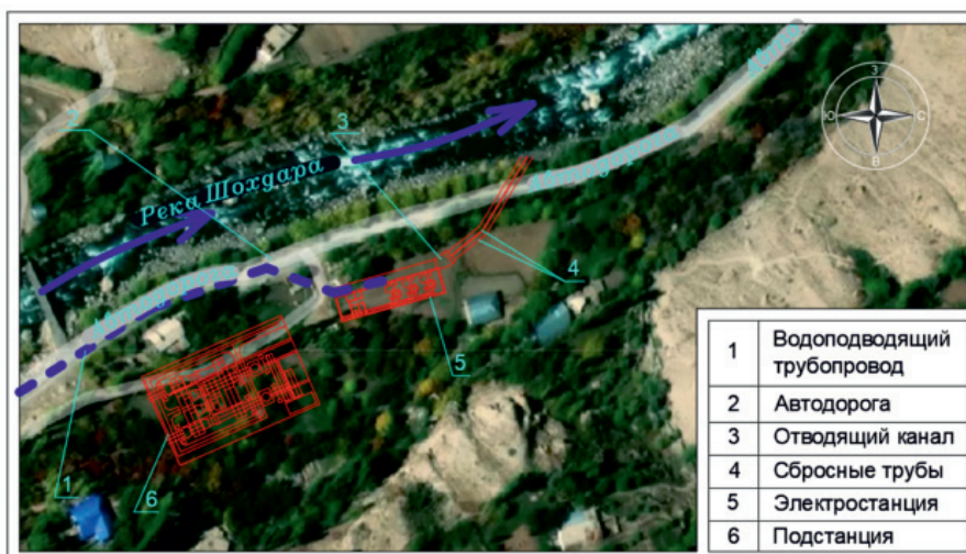
Рис.7. Схема расположения электростанции и подстанции. 1-водоподводящий трубопровод; 2-автодорога; 3-отводящий канал; 4-сбросные трубы; 5-электростанция; 6-подстанции
