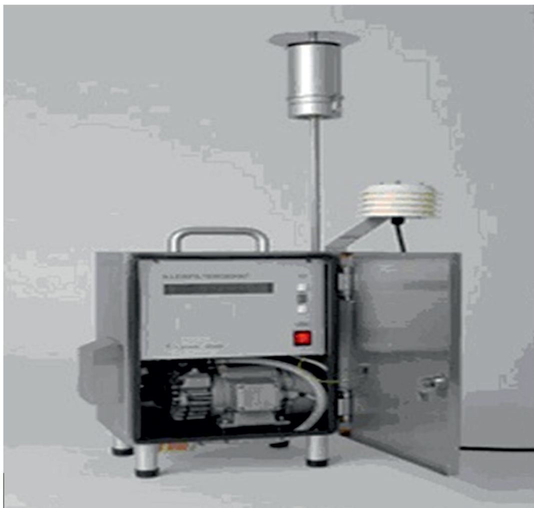
Рис. 1. Средний по объему автоматический пробоотборник с 10 микрометром размером пор (PM10).
