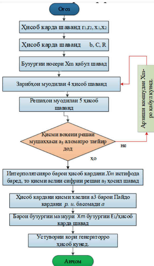
Расми 3. Блок-схемаи барномаи компютерӣ барои муайян кардани устувории ҳолати генератори асинхронӣ
