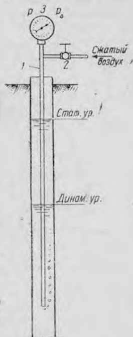
Рис. 9. Пневматический указатель уровня: 1—трубка малого диаметра; 2—вентиль; 3—чувствительный манометр.
