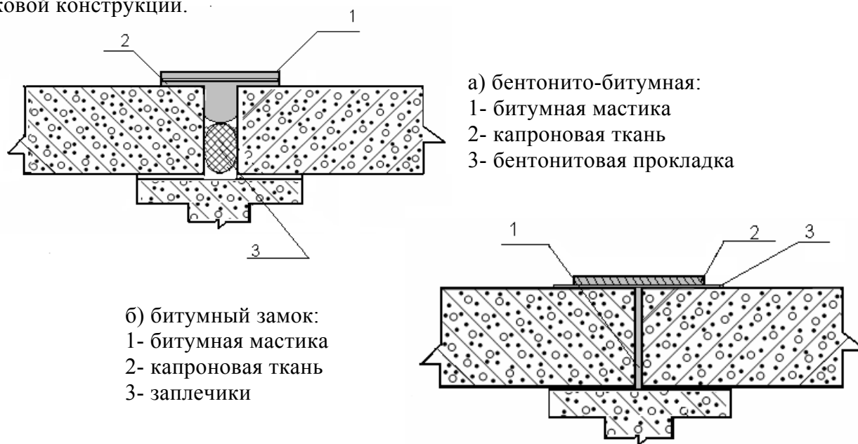
Рис. 1. Варианты уплотнения стыков-лотков
