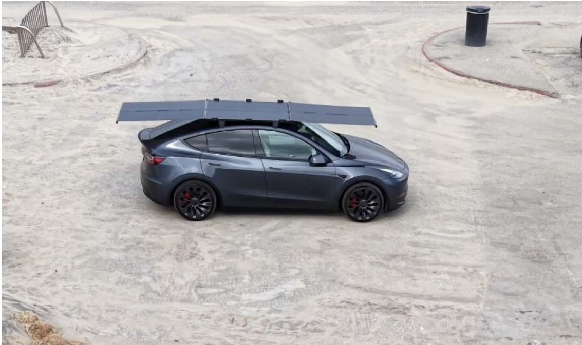
Багажник с солнечным модулем от DartSolar
