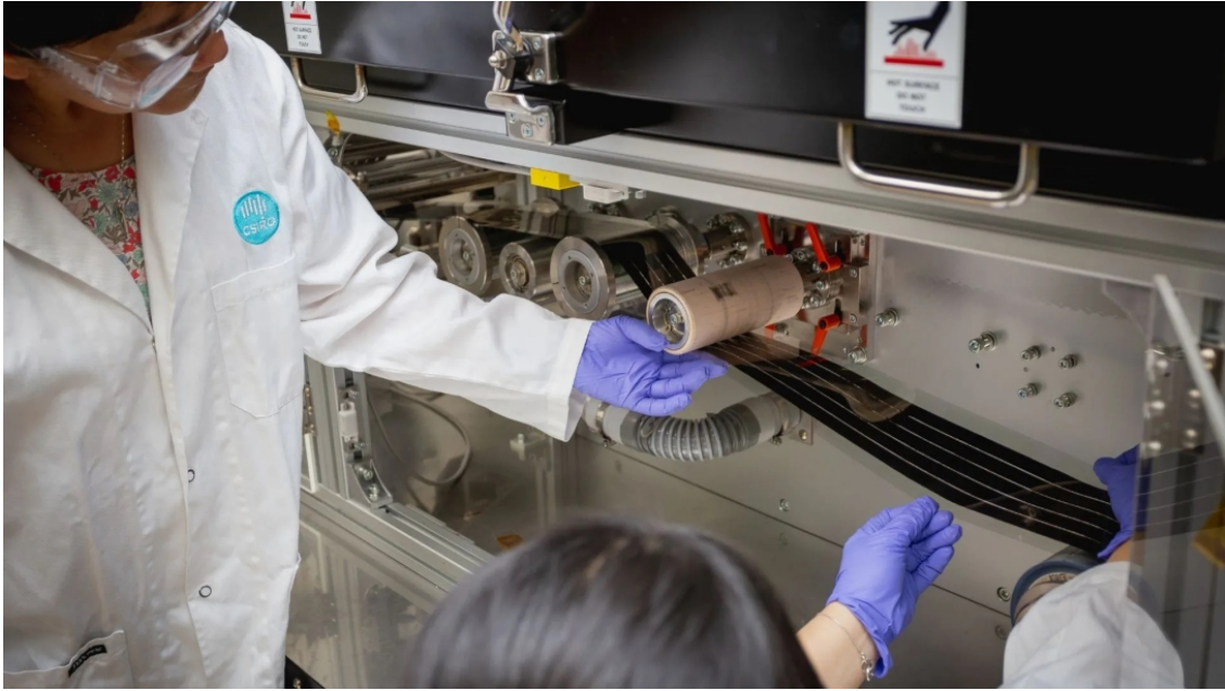
Печать гибких солнечных батарей. Фото: CSIRO
