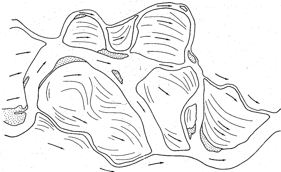
Рис. 68. Пойменный массив при незавершенном меандрировании. Течения на пойме согласуются с рельефом ее поверхности и направлением проток во все фазы развития транзитного потока.
