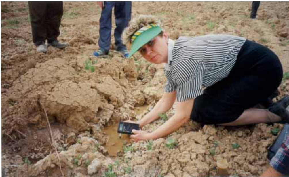
Отечественный прибор показывает высокую минерализацию грунтовой воды на поле в х-ве 22, Сурхандарья
