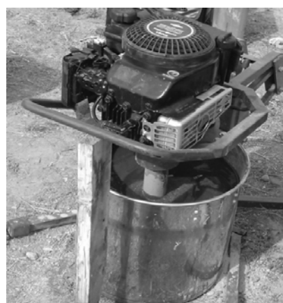
Рис. 2. Механоактиватор с приводом от ДВС (приготовление рабочего раствора на поле)
