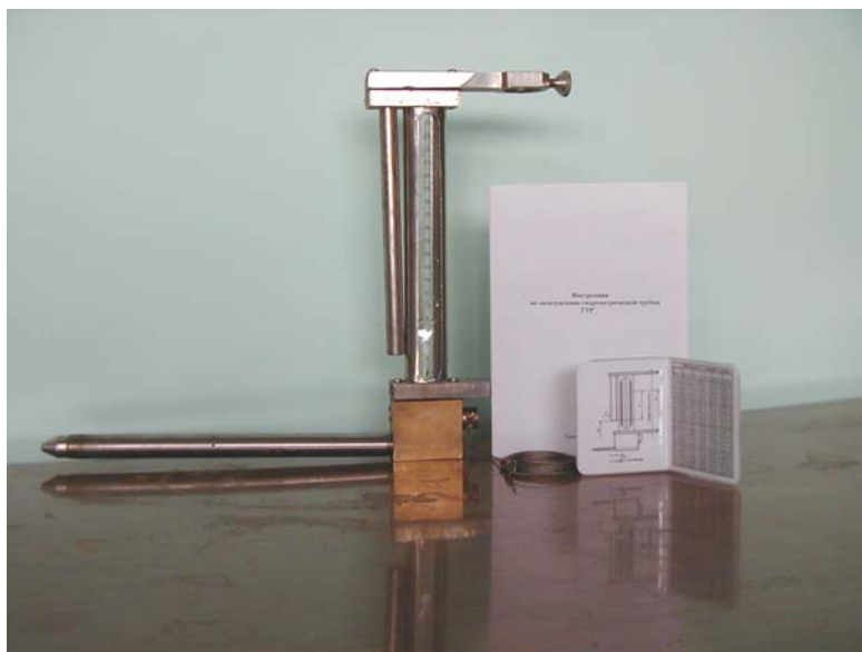
Рис. 4. Гидродинамический измеритель скорости потока ГТР
