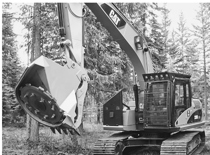
Рисунок 2 – Навесной мульчер дискового измельчения с приводом от гидравлики экскаватора ( https://lesprominform.ru/uploads/images/lpi70/diskovyy_avesnoy_izmelychitely.jpg )
