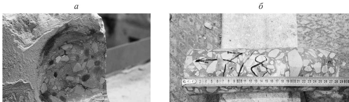
а – образец керна с Волжской ГЭС; б – образец керна с Саратовской ГЭС
