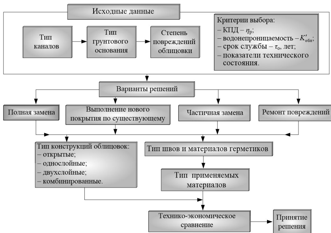
Рисунок 5 – Алгоритм выбора варианта восстановления бетонных облицовок каналов
