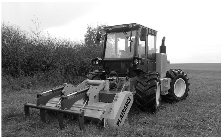
Рисунок 5 – Самоходный колесный мульчер ( http://mulcherplus.ru/assets/images/resources/25/dscn1932.jpg ) Figure 5 – Self-propelled wheeled mulcher ( http://mulcherplus.ru/assets/images/resources/25/dscn1932.jpg )
