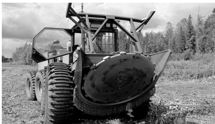
Рисунок 1 – Навесной мульчер дискового измельчения с приводом от вала отбора мощности ( https://topmulcher.ru/wp-content/uploads/2018/08/IMG_8334.jpg )
