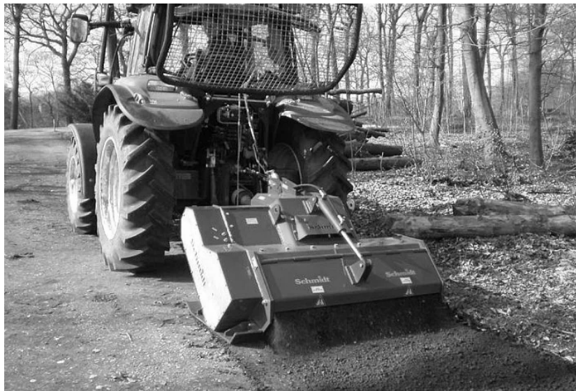
Рисунок 7 – Навесной грунтовый мульчер с приводом от вала отбора мощности трактора ( http://www.specserver.com/ads_upload/files/20130930095810.JPG )
