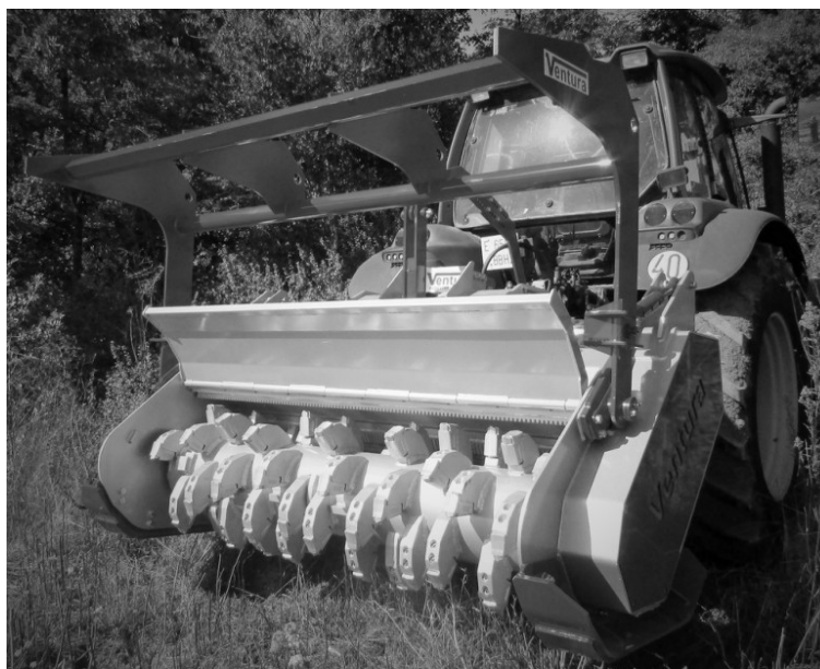
Рисунок 3 – Навесной мульчер роторного измельчения с приводом от вала отбора мощности ( https://kompanialesna.pl/1326-large_default/mulczer-lesny-ventura-tfmf-200.jpg ) Figure 3 – Mounted PTO-driven rotary mulcher ( https://kompanialesna.pl/1326-large_default/mulczer-lesny-ventura-tfmf-200.jpg )
