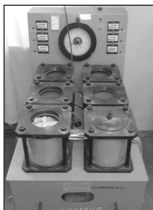
Рисунок 2 – Лабораторная установка для определения водонепроницаемости образцов бетона со ступенчатым подъемом давления воды по 0,2 МПа
