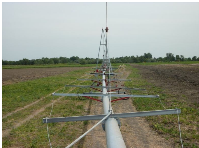
Рисунок 12 – Вид на тросовые опоры и конструкцию фермы ДМ «Фрегат»
