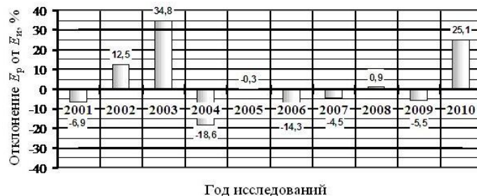
Рисунок 4 – Отклонение величин суммарного испарения, измеренного испарителем и рассчитанного по формуле (1), % (2001–2010 гг.)
