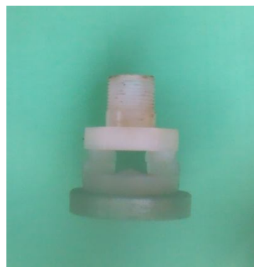
Рисунок 1 – Дождевальная насадка кругового полива с дефлектором «обратный конус»
