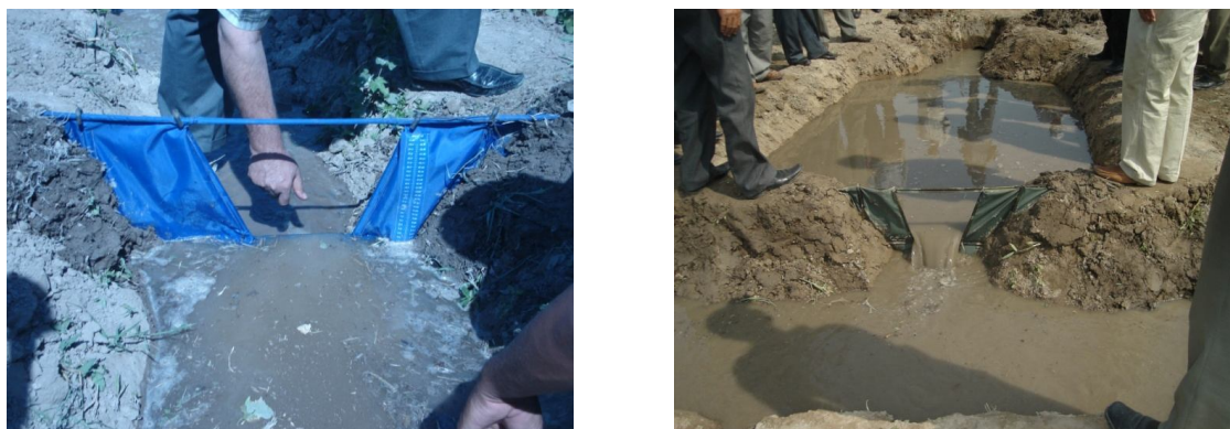
Рисунок 2 – Установка водослива в полевых условиях
