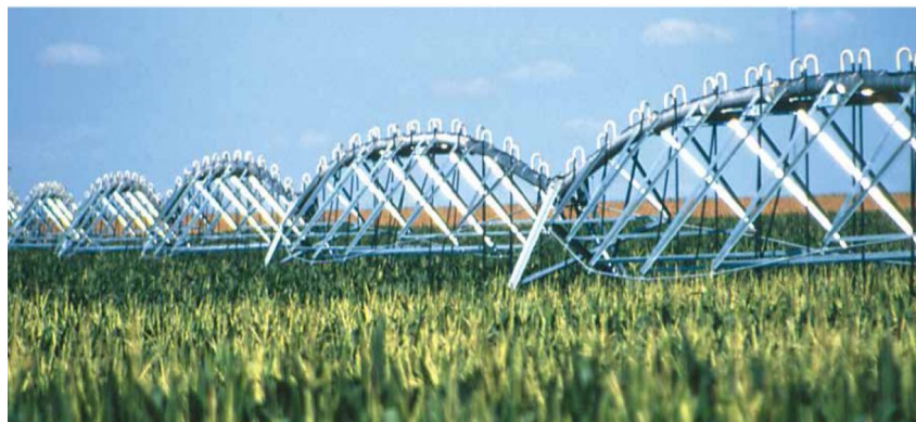
Рисунок 6 – Общий вид конструкций трубопровода и фермы дождевальной машины фирмы «Zimmatic»
