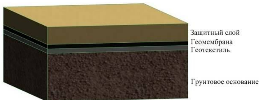
Рисунок 5 – Конструкция комбинированного противофильтрационного экрана
