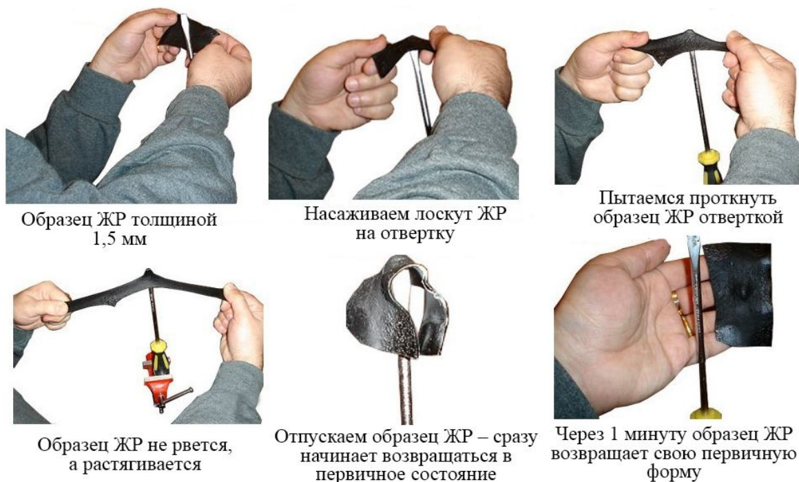
Рисунок 2 – Сопротивление затвердевшей резины прокалыванию
