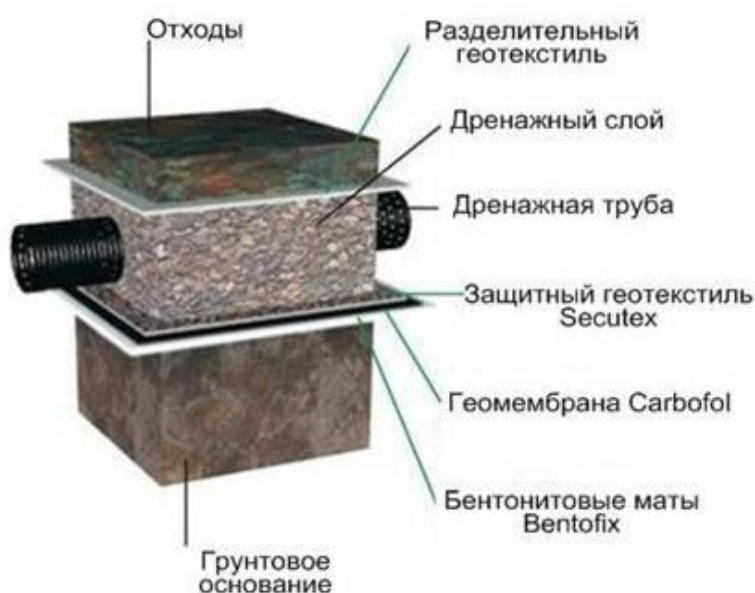
Рисунок 4 – Конструкция функциональных слоев основания накопителей от NAUE
