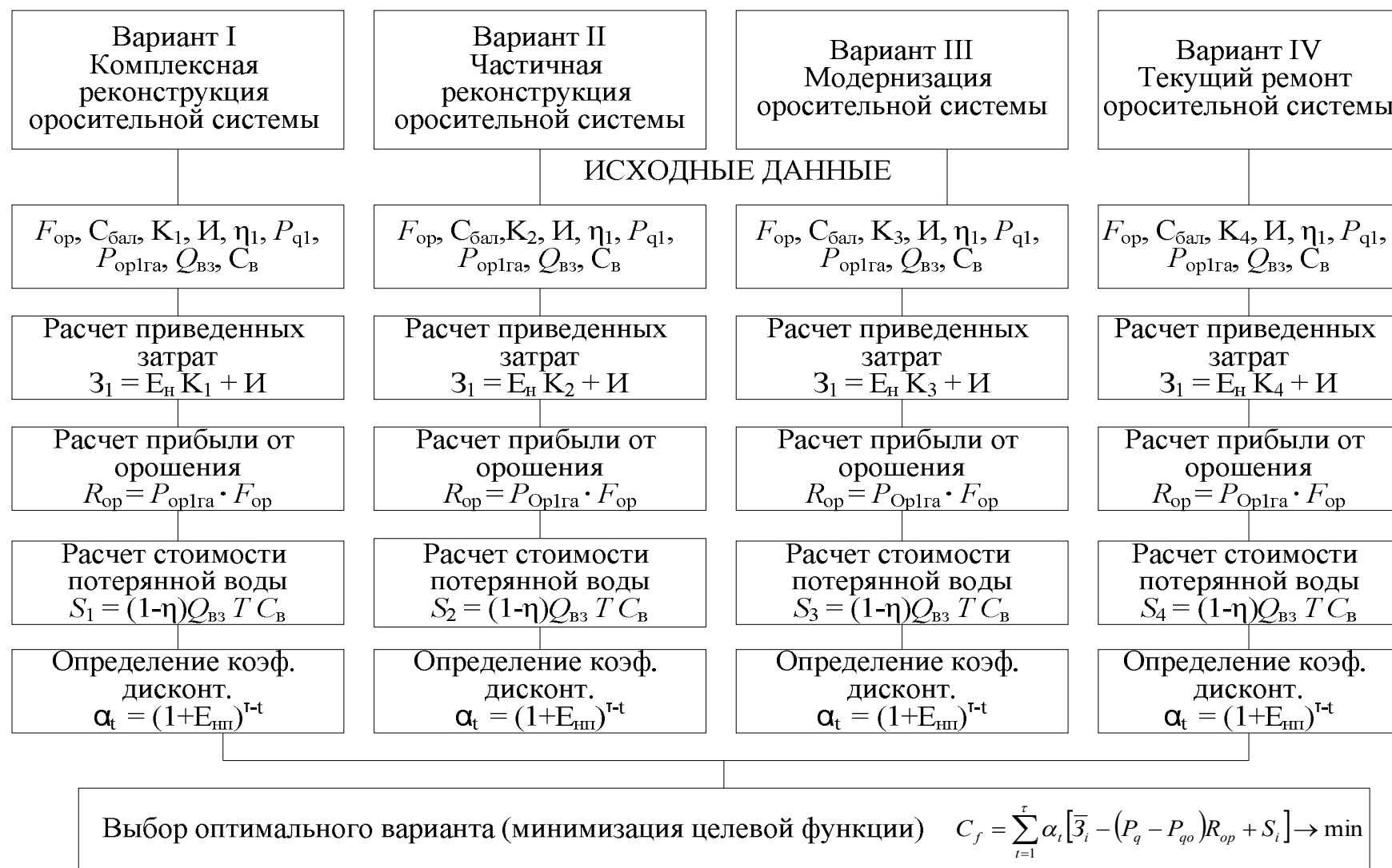
Рис. 1. Схема алгоритма компьютерного расчета выбора оптимального варианта реконструкции и модернизации оросительной системы
