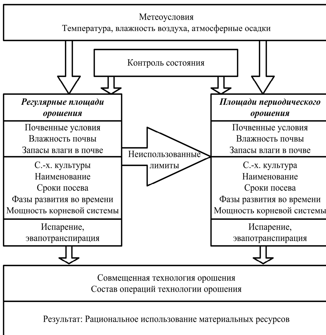
Рис. 1. Схема рационального применения неиспользованных лимитов воды на площадях периодического орошения
