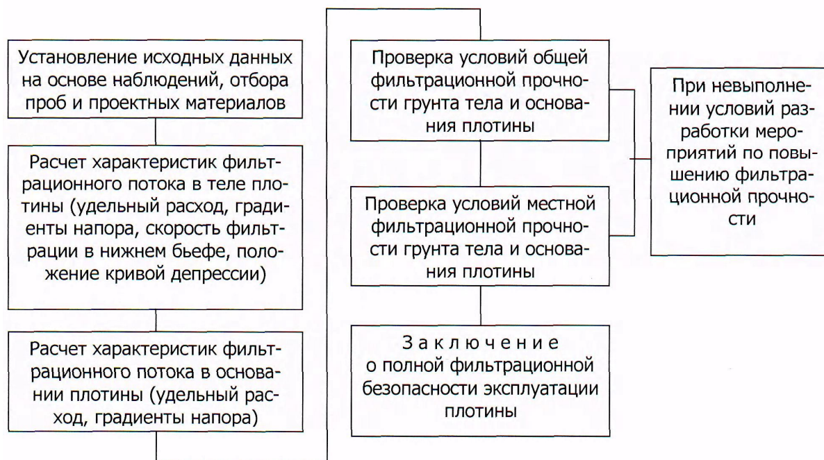
Рис. 1. Общая схема алгоритма расчета фильтрационной безопасности земляных плотин III и IV класса капитальности
