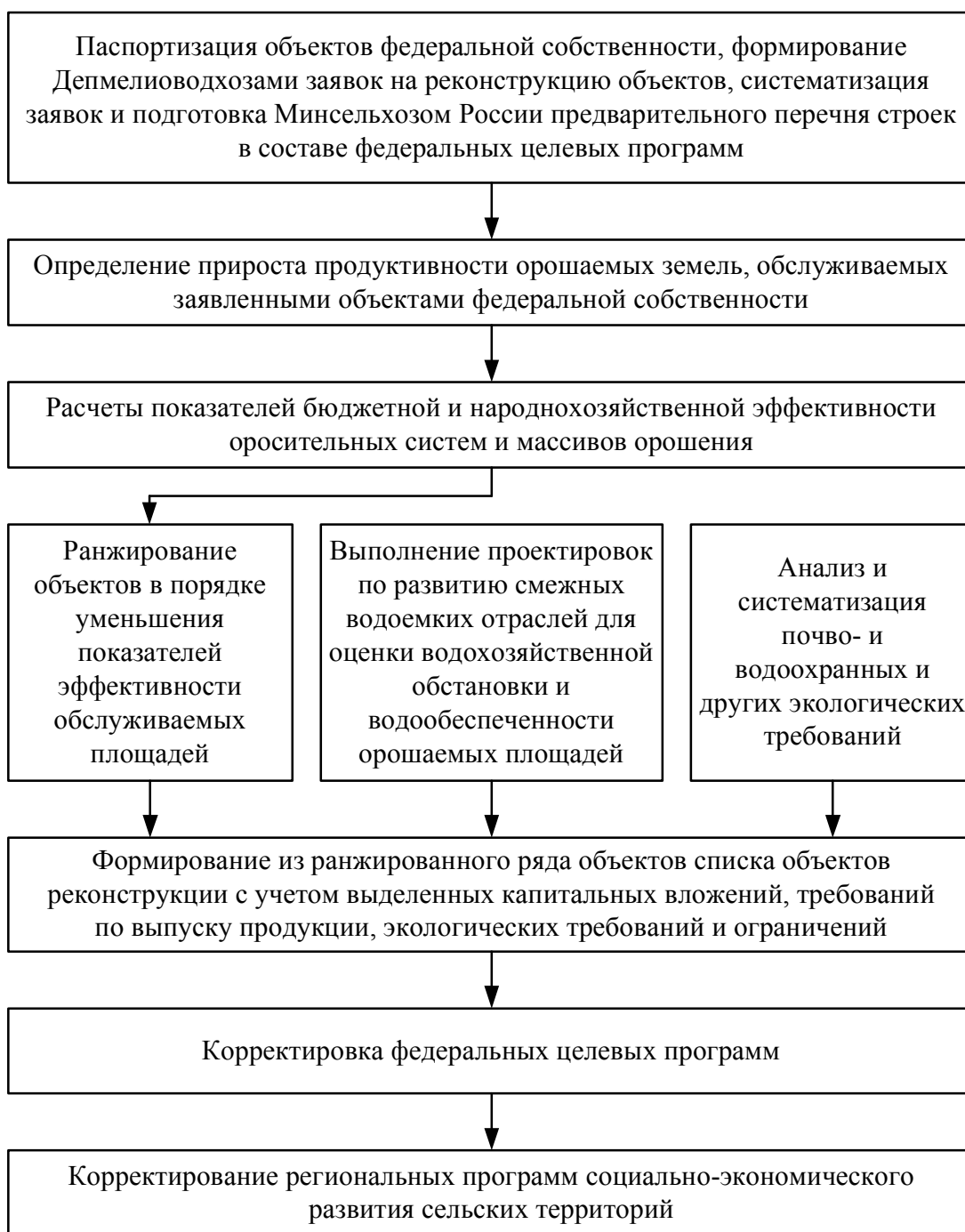
Рис. 1. Технологическая схема обоснования реконструкции объектов федеральной собственности
