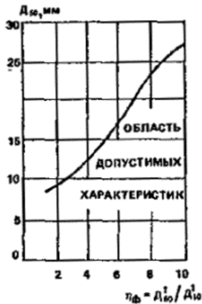
Рис. 128. График для подбора первого слоя фильтра в суглинистых грунтах (с диском пластичности w_n \geq 7 ) при любой схеме движения воды
