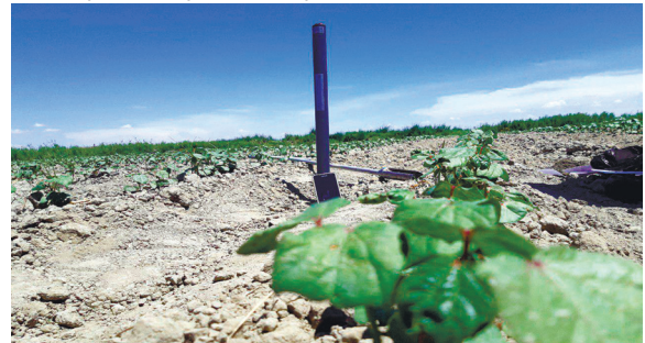
Рис.1. Процесс измерения почв с помощью прибора UMP-1 Environmental-Device-Technology (Umwelt-Geräte-Technik GmbH)
