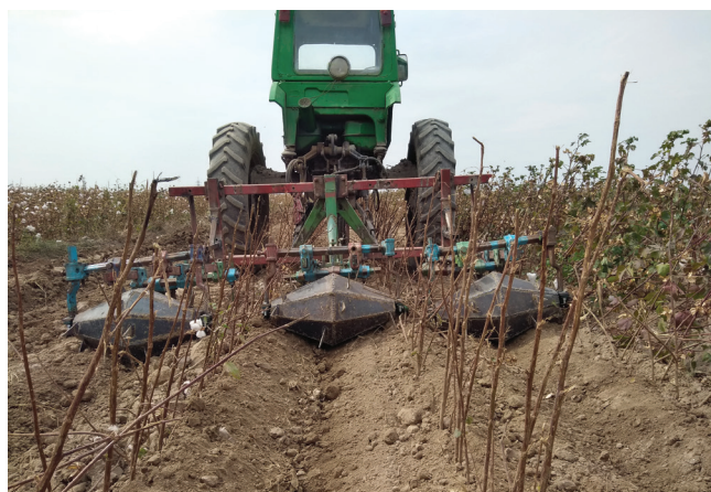
6-расм. Экспериментал машина ишчи органларининг юмшатишган эгат шаклини ҳосил қилиш иш жараёни
