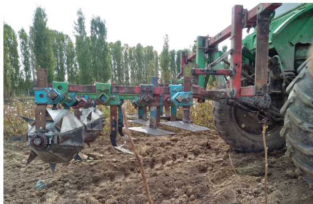
5-расм. Экспериментал машина ишчи органларининг ўрнатилиши
