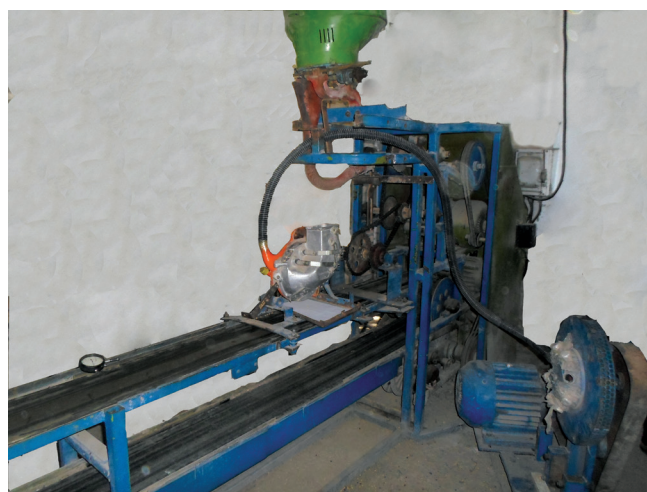
1-расм. Экиш аппаратларини синаш учун мўлжалланган универсал стенд
