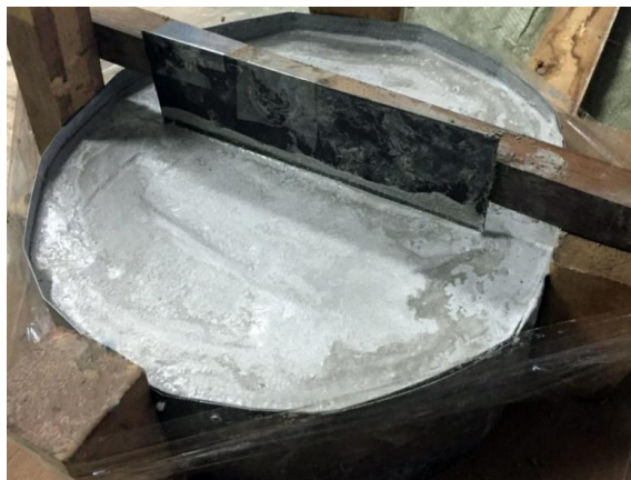
Рисунок 3 – Затвердевший образец с искусственно созданным повреждением в виде продольной трещины (автор фото А. Ю. Гарбуз)
