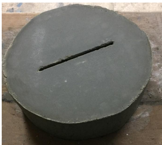
Рисунок 4 – Готовая модель бетонной облицовки с повреждением в виде сквозной шероховатой трещины (автор фото А. Ю. Гарбуз)
