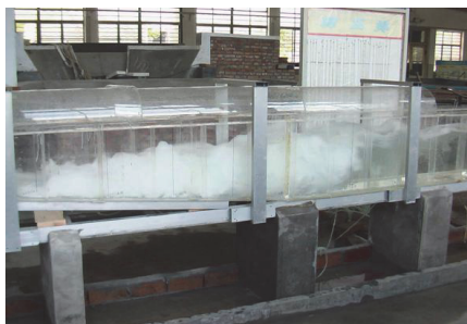
Рис. 7. Исследование гидротехнического туннеля на модели
