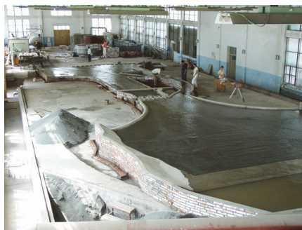
Рис. 6. Исследование регулирования русел за водозабором на модели
