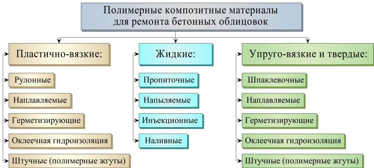
Рисунок 1 – Полимерные композитные материалы, применяемые для ремонта бетонных облицовок каналов Picture 1 – Polymer composites used for the concrete canal lining repairing
