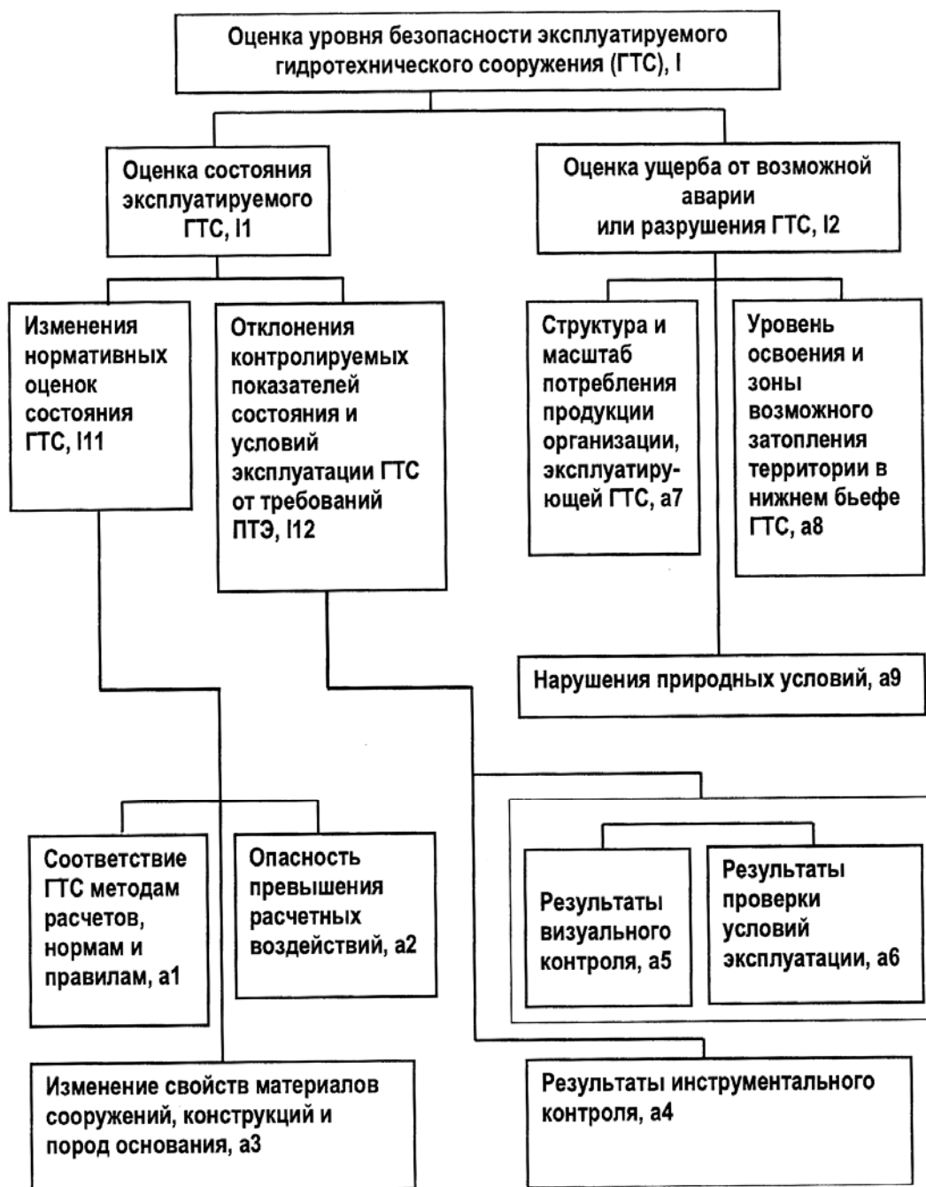
Рис. 3.1. Структура факторов безопасности и схема оценки их влияния на безопасность эксплуатируемых ГТС
