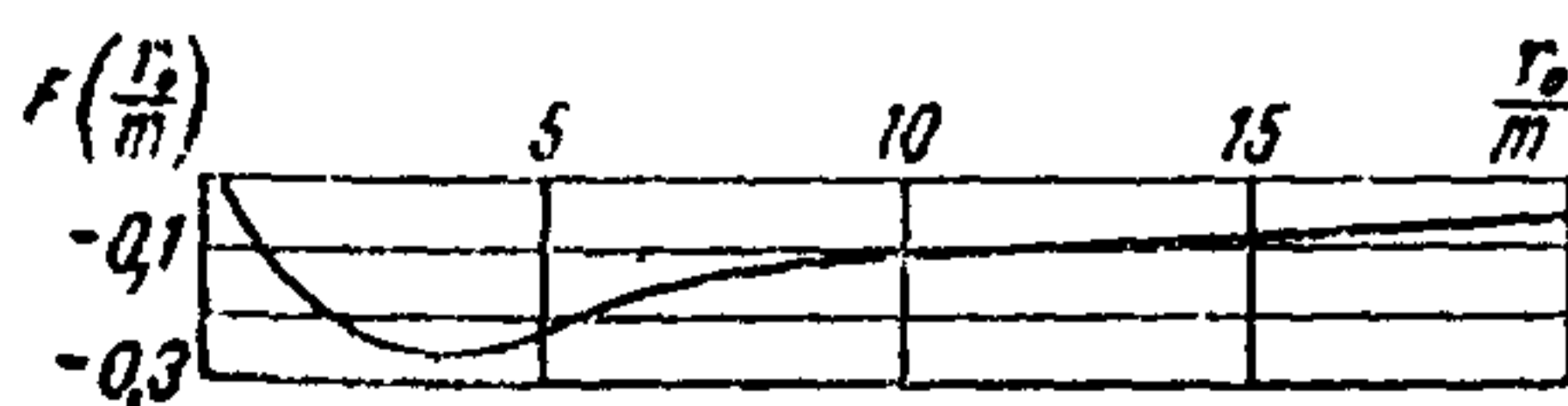
Рис. 97. График функции F \left( \frac{r_0}{m} \right) для определения положения уровня в центре кольцевой горизонтальной дрены
